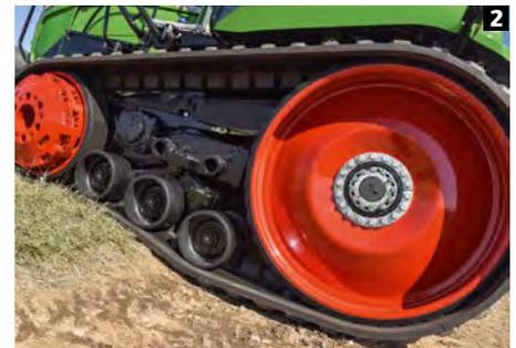
Mit dem 26-Zoll-Raupenlaufwerk wird beispielsweise eine Aufstandsfläche von 2,55 m<sup>2</sup> erreicht, bei einer Außenbreite von unter 3,3 m.
