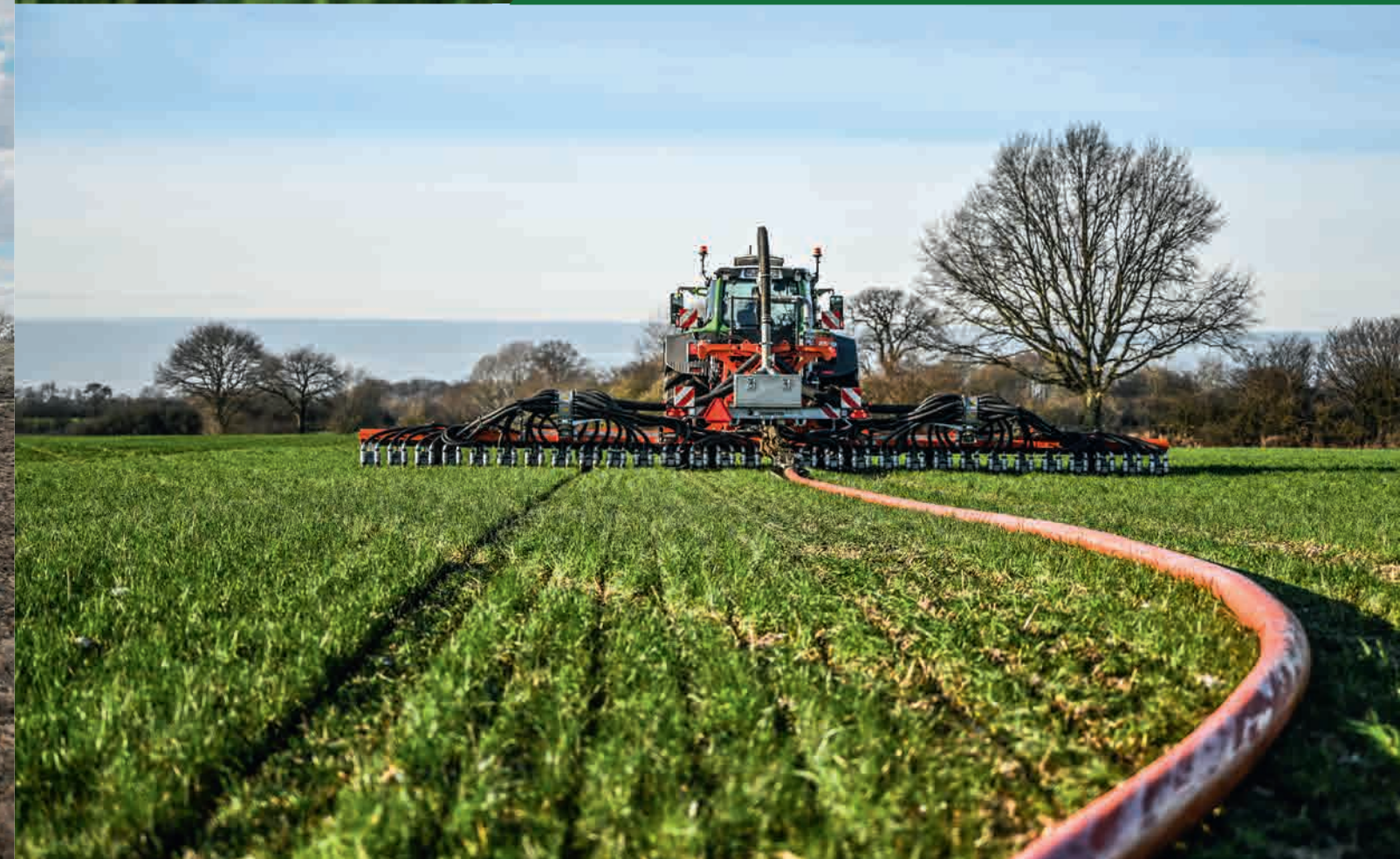
Ausbringen auf nassen Böden: per Verschlauchung und Einarbeitung mit 12 m Grünlandschlitz — vergrößert das Zeitfenster
