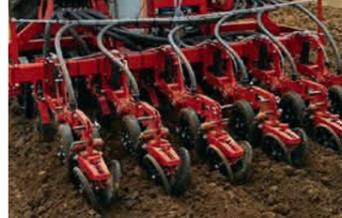
Innovative Unterfuß-Flüssigdüngung für effizienteren Maisanbau, (Versuchsmaschine) 2021
