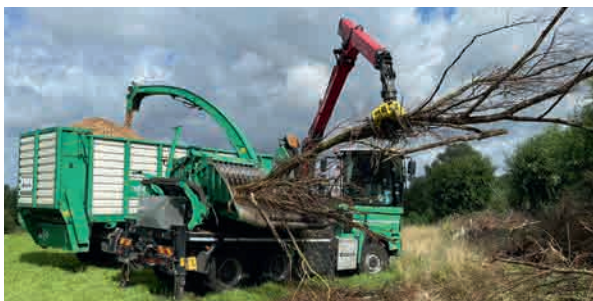
Erzeugung von HolzHackSchnitzeln
